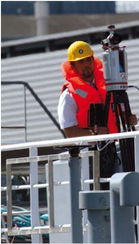
Terrestrischer Laserscanner mit Techniker an Bord der »Marie Louise«
