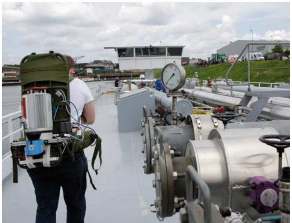
Michael Bleier schreitet mit seinem Rucksackscanner das Deck des Schiffes ab.
